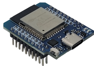
Abb. 5: ESP32 D1 Mini mit Pinheader
